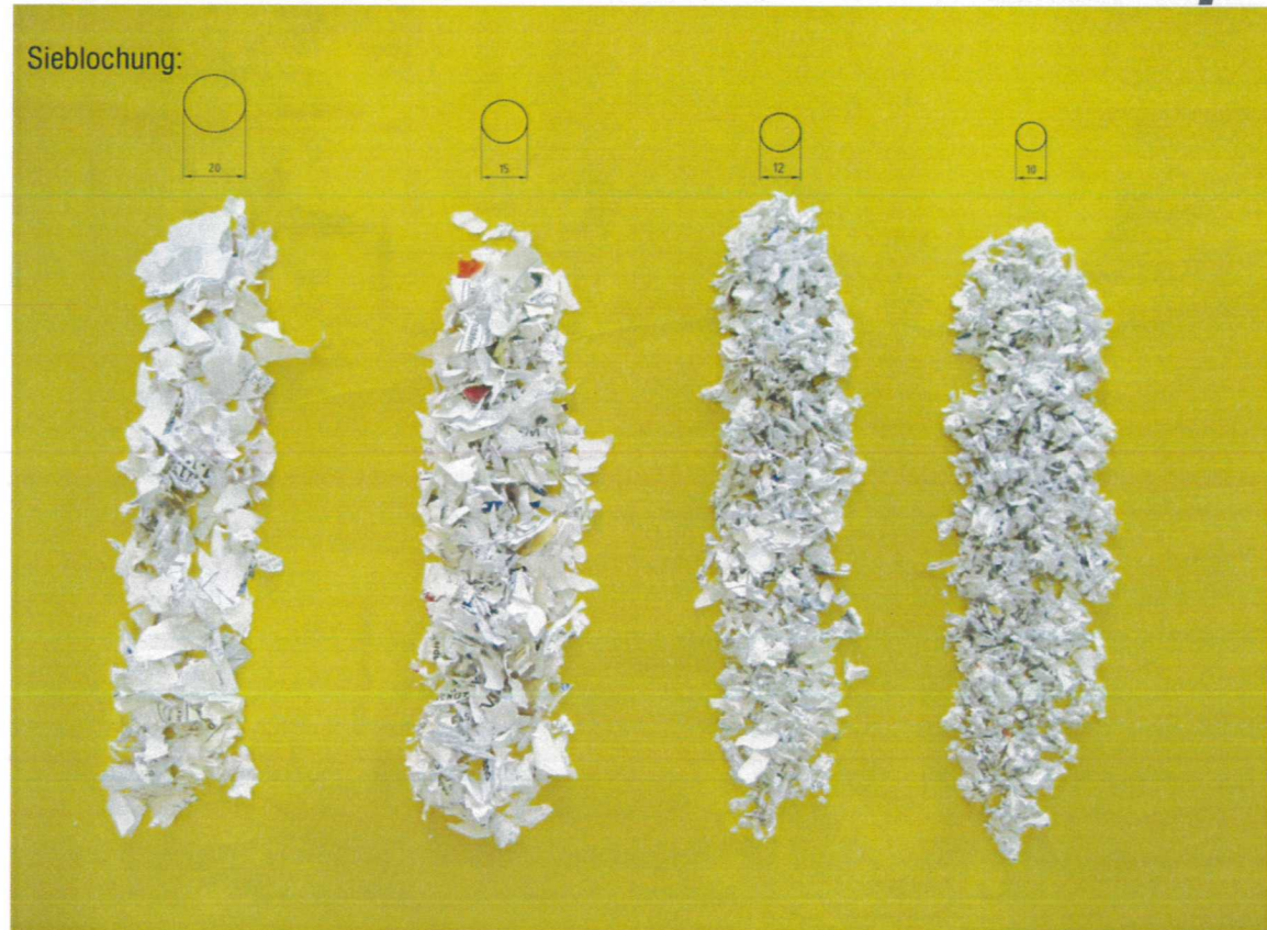
Bild 1: Granulat bei Sieblochung 10; 12; 15; 20 mm (verkleinerte Darstellung)
